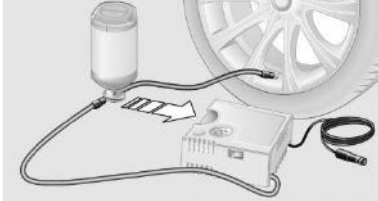
۵. شلنگ پرکننده ی محفظه ی درزگیر را به والو تایر چرخ معیوب، پیچ کنید.
