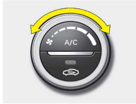
کلید کنترل سرعت فن
