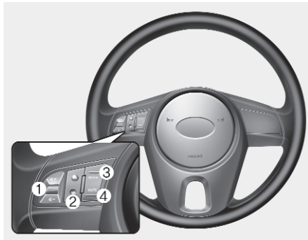
کلیدهای کنترل از راه دور سیستم صوتی
