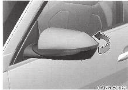
نوع دستی (در صورت مجهز بودن) برای جمع کردن آینه بغل، بدنه آن را گرفته و به سمت عقب خودرو جمع کنید.
