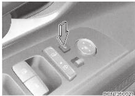
نوع برقی (در صورت مجهز بودن) برای جمع کردن یا باز کردن آینه برقی، کلید را فشار دهید. در صورتی که سرعت خودروی شما بیش از ۱۵ کیلومتر بر ساعت باشد آینه‌های بغل جمع نمی‌شوند حتی اگر کلید فشار داده شود. اگر کلید فشار داده نشود، آینه موقع باز و بسته نمودن قفل درب‌ها از بیرون، به صورت خودکار جمع شده و باز می‌شوند.
