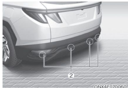
[۱]: دوربین دید عقب [۲]: سنسورهای اولتراسونیک عقب
