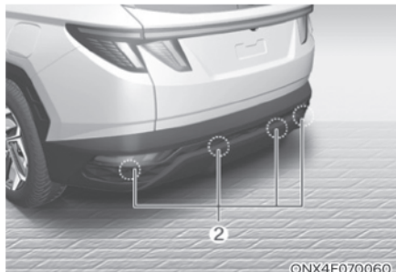
1] سنسورهای اولتراسونیک جلو 2] سنسورهای اولتراسونیک عقب
