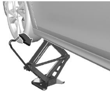
از قرار گرفتن لبه‌ی بدنه‌ی خودرو بر روی شکاف (شیار) جک اطمینان حاصل کنید.
