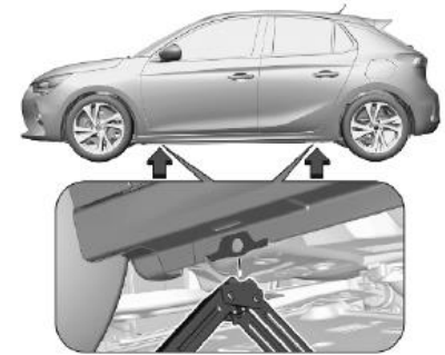
۳. از قرار داشتن جک درست در زیر نقطه‌ی مخصوص اطمینان حاصل کنید.
