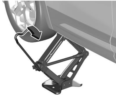
در حالی که جک به درستی تراز شده است، جک را بالا ببرید تا زمانی که چرخ از زمین جدا شود. ۵. پیچ های چرخ را باز کنید. ۶. چرخ را عوض کنید.
