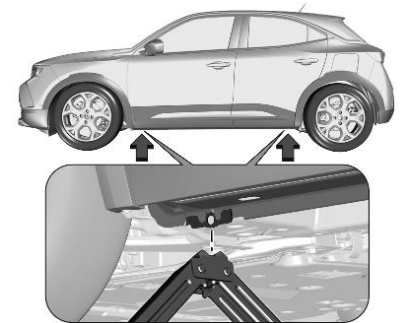
۳. مطمئن شوید که جک به درستی در زیر نقطه جک مربوطه قرار گرفته است.
